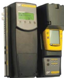
Las configuraciones de difusión y bombeo son compatibles con el sistema automático de calibración y prueba de respuesta MicroDock II
